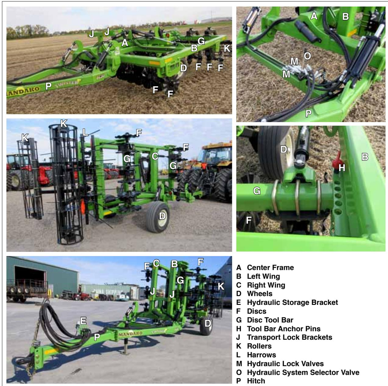
Fig. 1 PRINCIPLE COMPONENTS
