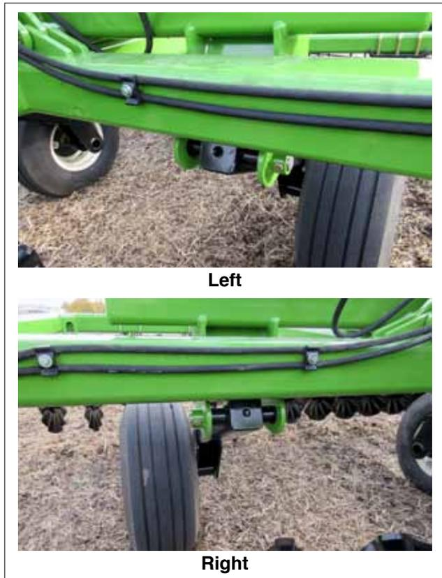
Fig. 41 WHEEL PIVOT (TYPICAL)
