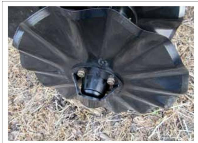
Fig. 42 DISC BEARING HUB (TYPICAL)
