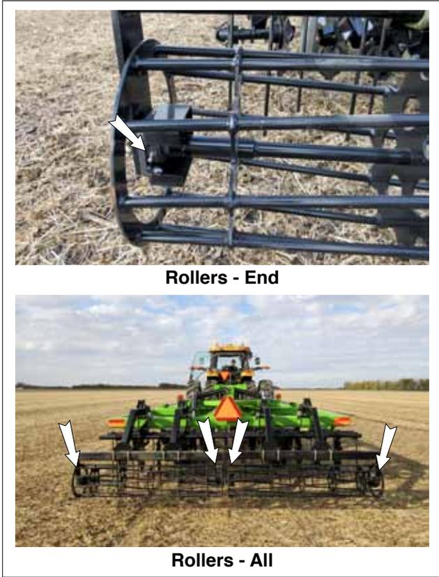
**Fig. 43 ROLLER BEARINGS (TYPICAL)**
